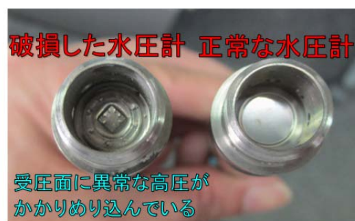
図-11 超破損した水圧計の受圧面
