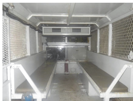
写真-3 水冷式冷房搭載人車内部
