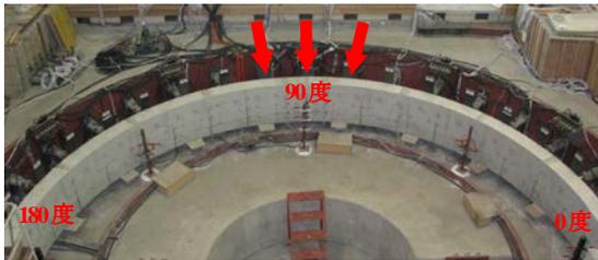
図-2 覆工载荷実験の状況
