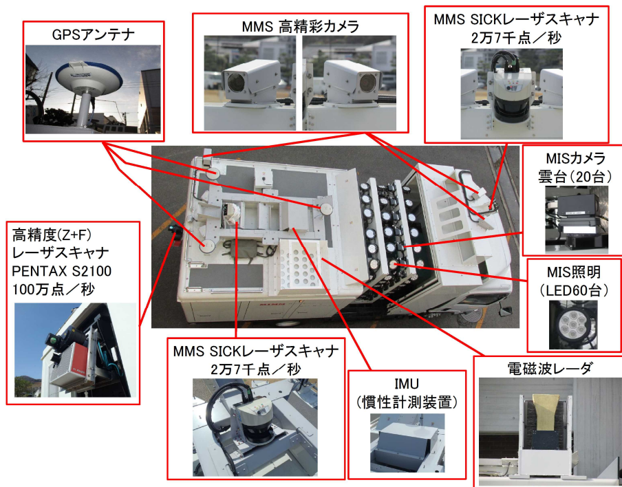
図-1 走行型計測車両 MIMM-R の計測システム
