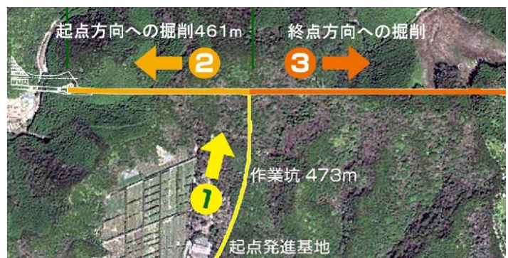
図-1 掘削順序図
