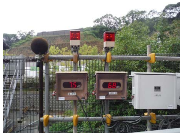
写真-12 エキセントリックリップパ騒音測定状況
