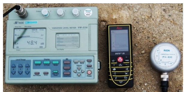
写真-13 エキセントリックリップパ振動測定状況
