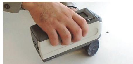
写真-1 分光測色計による色調の測定
