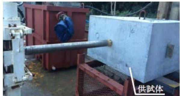
写真3 供試体削孔試験状況
