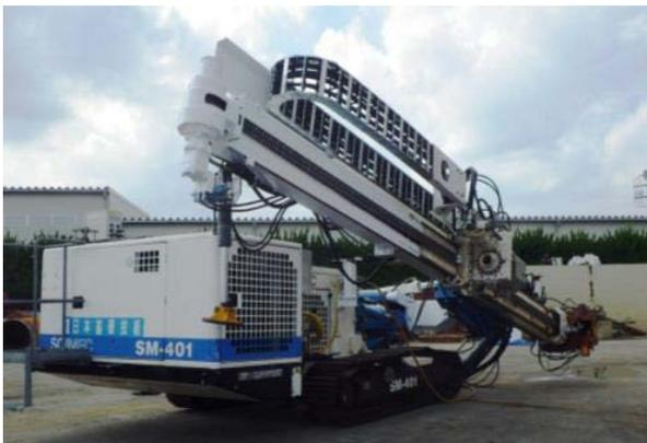
写真-1 ロングフィード式ボーリングマシン
