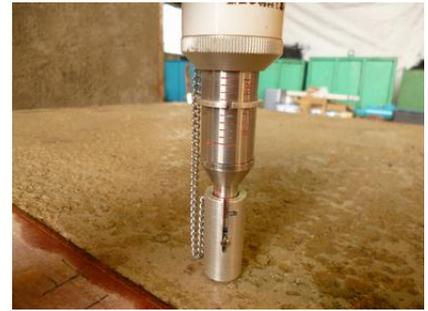
図-4 針貫入試験による強度確認
