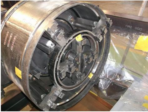
図-1 二重回転カッター構造の実験機
