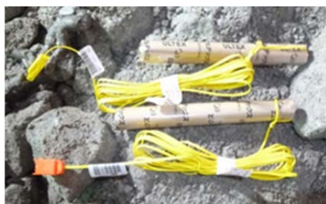
写真-4 親ダイ（高精度電子雷管（eDev II））
