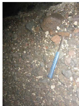
図-4.3 62k600m 付近で観察された火山灰・軽石層 (Aso-4 4Ab) の近影
