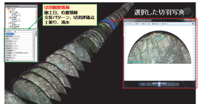
図-7 施工情報の取込み（切羽観察）
