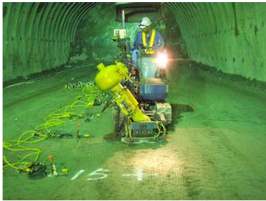
写真-1 S波用油圧インパクトによる左右打撃状況 12)
