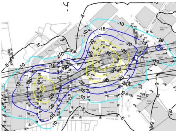
図-15 地表面沈下コンター図（予測）
