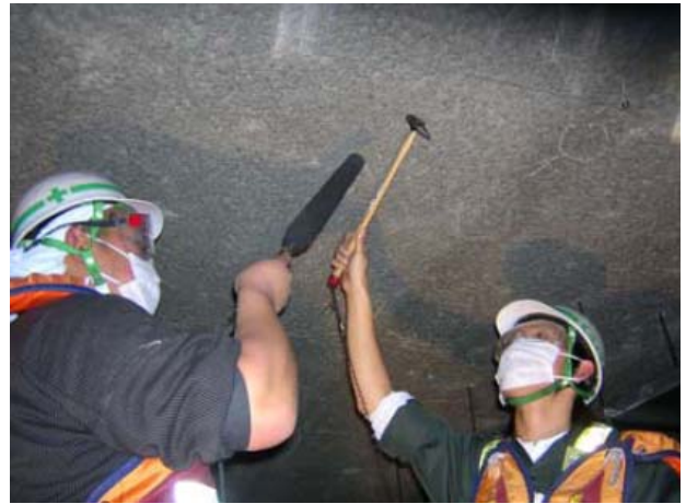
図-3 打音検査および集音状況
