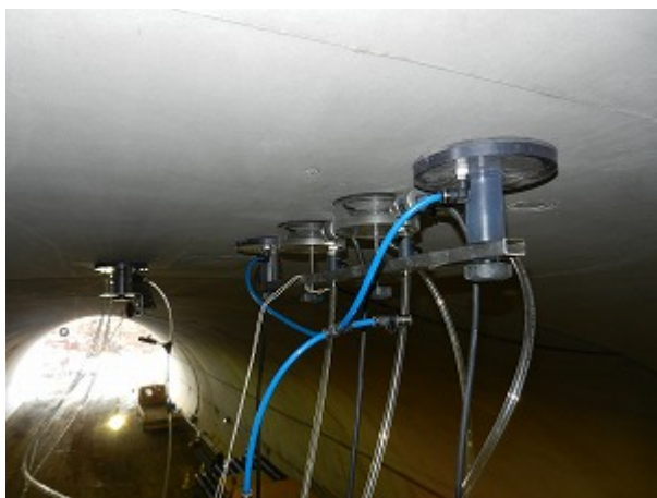
写真-4 SWAT測定状況（天端）
