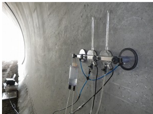
写真-3 SWAT測定状況 (SL)
