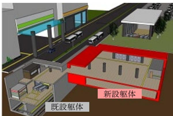
図-1 地下駅拡幅工事のイメージ
