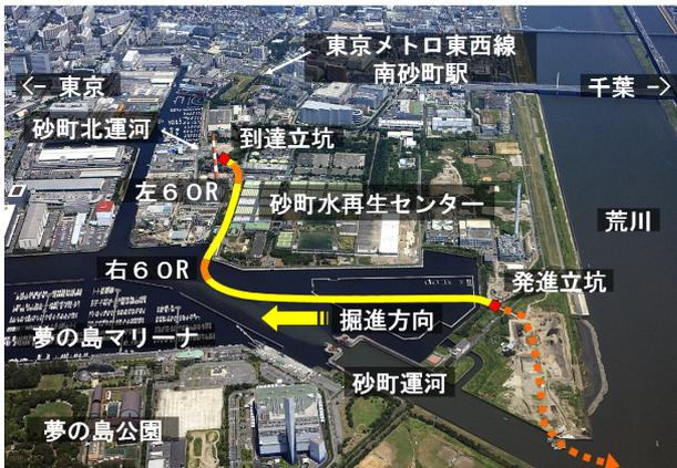
写真-1 東京都砂町水再生センター雨水放流渠概要
