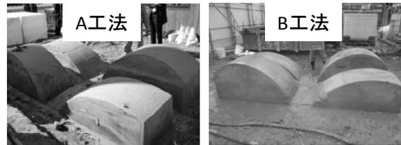
写真-2 両工法の充填結果
