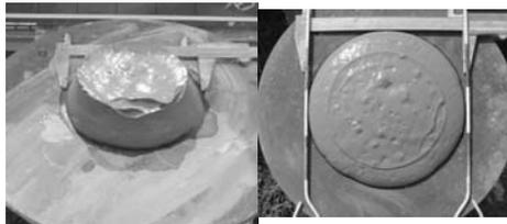
写真-1 フロー試験結果
