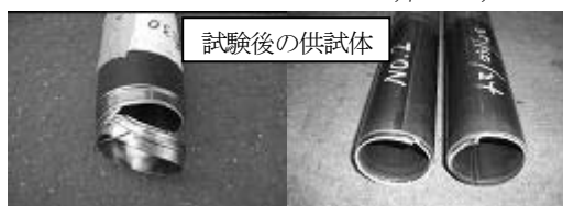
図-2 引張強度試験結果（ネジ部、溶接継手部）
