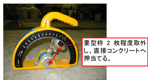
写真-8 低強度用シュミットハンマー
