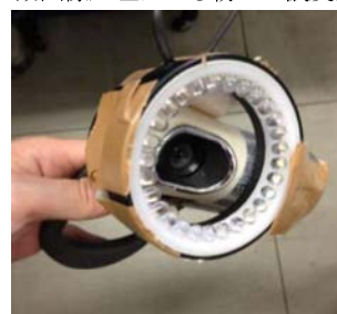
写真-3 粉じん散乱光取得部構成
