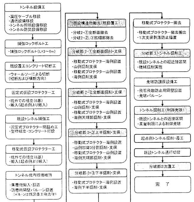
図-6 分岐部施工フロー
