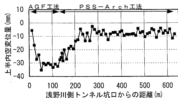
図-13 海側(後行)トンネルの内空変位量
