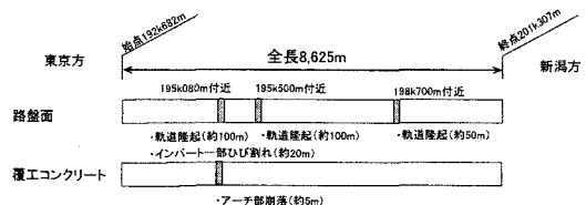
図-2 魚沼トンネル全体被害状況
