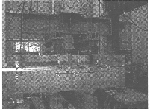
写真-1 大型供試体曲げ靱性試験実施状況
