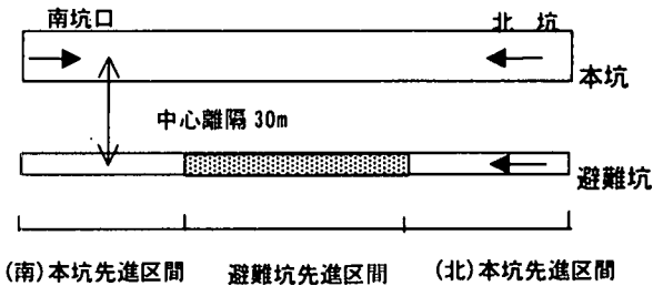
図－1 トンネル掘削の概要
