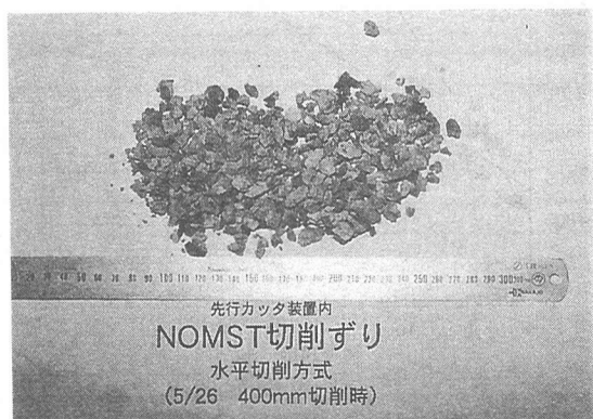
図-11 装置排出口部切削ずり（水平切削方式）
