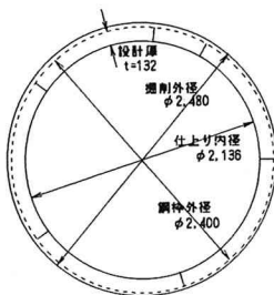
図-6 覆工断面図
