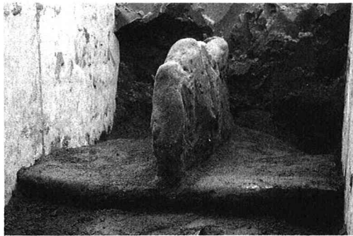
写真-1 造成された逆T型固結体
