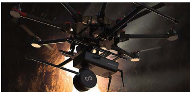
第6回小委員会 トンネル点検用UAV (みるくる資料)
