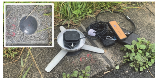
図-6 GNSS受信機の精度検証
