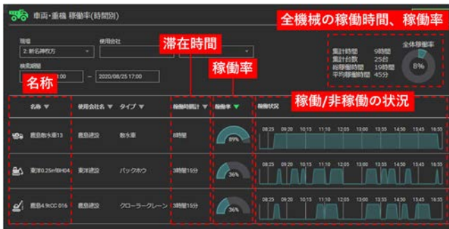
図-5 建設機械、車両の稼働時間・稼働率
