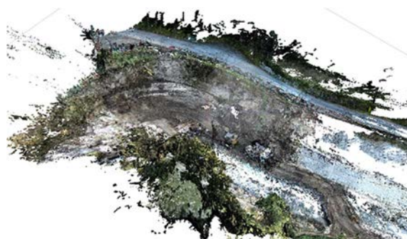
図5 ヘルメットカメラ映像から作成した 3次元点群データ
