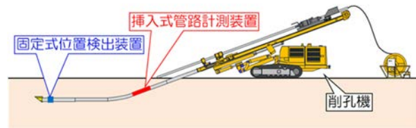
図-2 曲がり削孔位置検出システム
