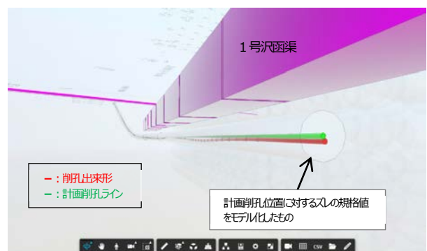
図-7 クラウドから確認した 3D 削孔出来形
