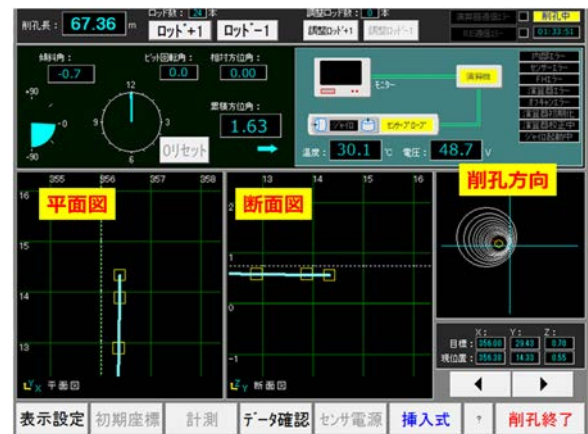
図-3 曲がり削孔機 2D 操縦モニター
