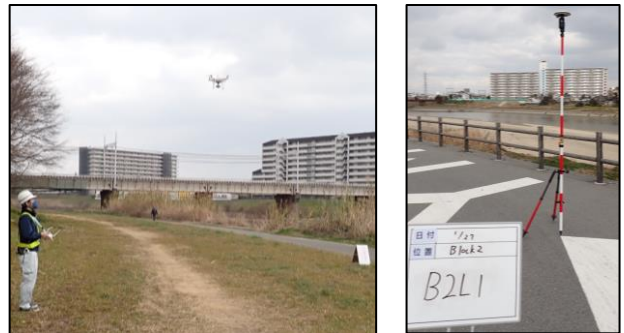
図-4 左：UAV の操縦、右：検証点計測
