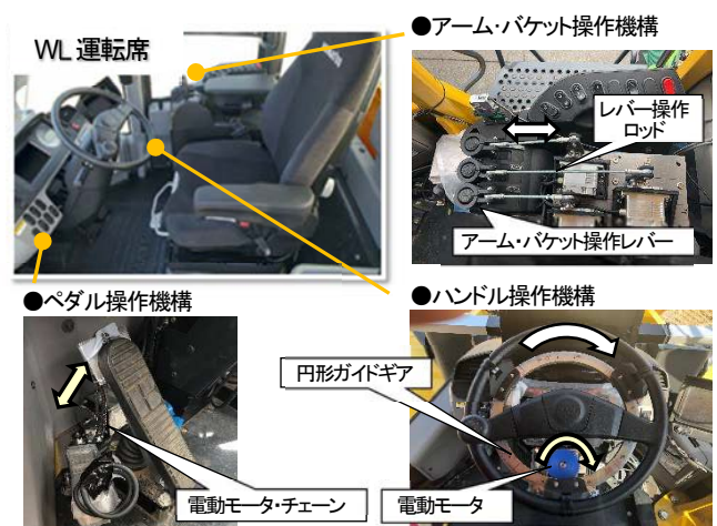
図-2 遠隔運転制御装置
