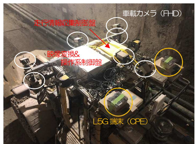
図-4 ホイールローダ搭載ユニット設置状況
