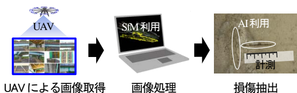
図-1 UAVによる点検方法
