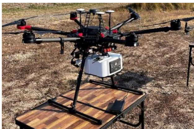
図-1 グリーンレーザドローン測量システムの外観
