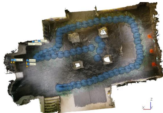
図-5 3次元モデルとカメラ撮影位置：青い球体が撮影位置を示す。
