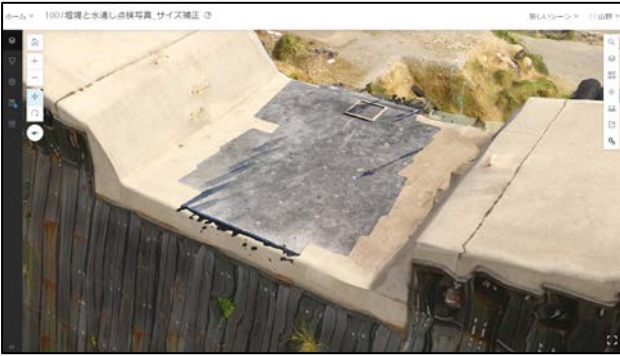
図-6 堰堤に貼り付けた点検写真
