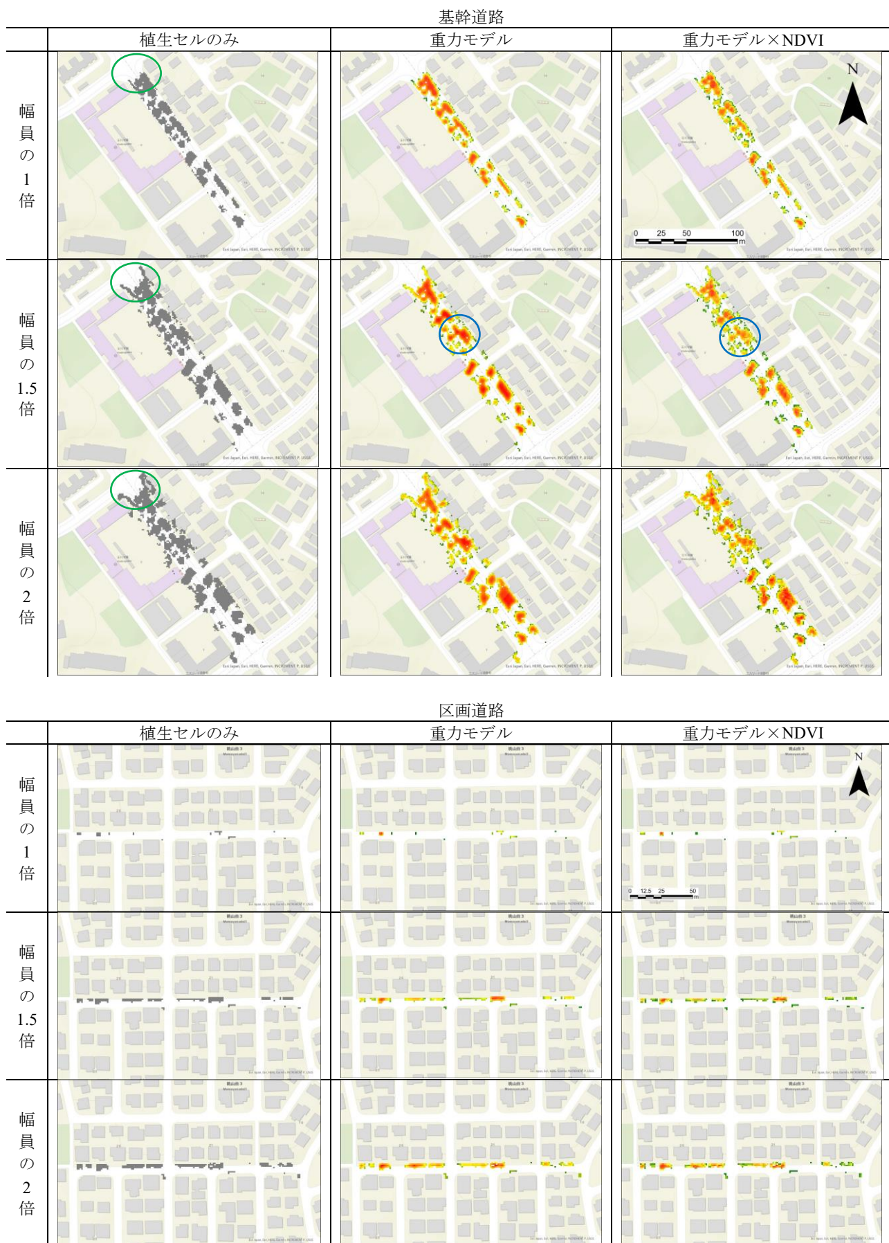
図-2 道路区分および各バッファ幅と各画像解析手法での結果の比較
