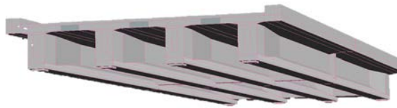
図-1 VRによるPCバルブTげた橋の3次元モデル
