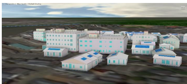
(a) 低い視点から見た自動生成した三国地区の3次元地形モデル上の建物モデル(堤防の高さ、地区の高さをGISモジュールで与えている)
