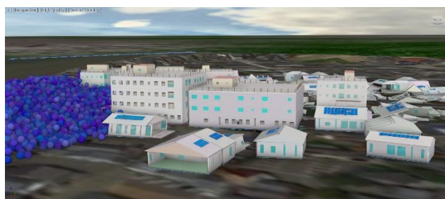
(b)「動的3次元建物モデル」は窓やドア等設置可能な壁に窓用に穴を開けた壁が「凸包立体の集まり」には変換していないので、窓が弾かれる
