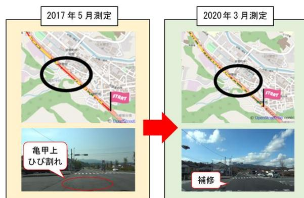
図-10 マップシステムによるデータの比較結果の一例
