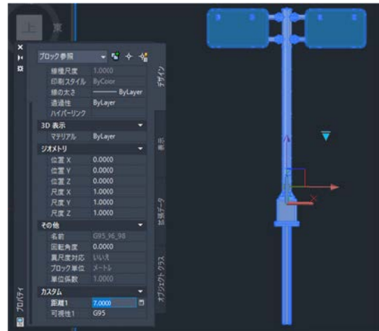
図-1 標識（F型）のパラメトリックモデル
