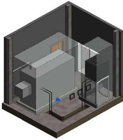
図-4 自家発電装置のパラメトリックモデル (Revit)
