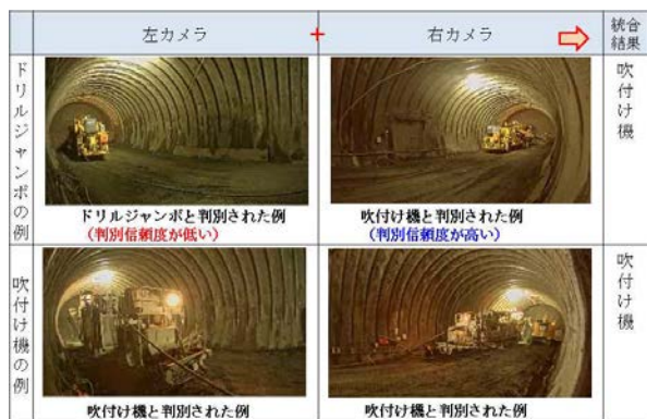
図-3 ドリルジャンボが吹付け機と誤判別された例
