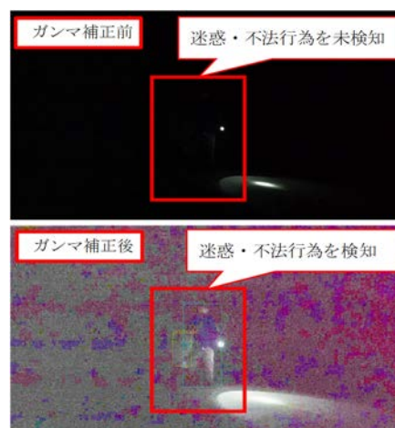
図-5 ガンマ ( \gamma ) 補正の適用による夜間の検知精度向上
