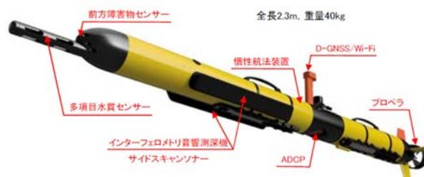
図-1 使用AUV諸元
