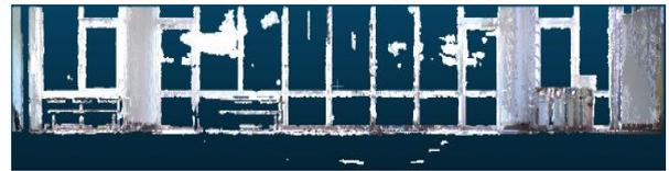
図-8 除去前の壁面の点群
